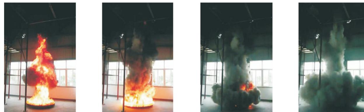
FFX-ACT8-CX型，安装高度8.5m,油盘(直径2.71m)模拟灭火演示
