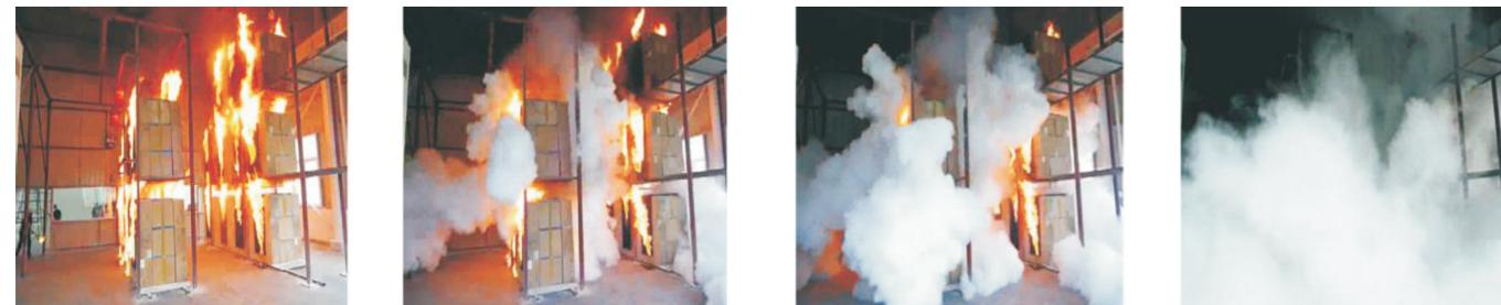
FFX-ACT8-CX型，安装高度7m,双排高架烟垛(长4.8m,宽各1.2m,高7m)模拟灭火演示
